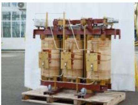
Трансформаторы типа ТСЗ-63,2500/6(10)-УЗ-Н сухие трехфазные негорючие, класс нагревостойкости - «Н», двухмоточные с естественным воздушным охлаждением защищенного исполнения с переключением ответвлений без возбуждения (ПБВ). Изготавливается для районов с умеренным климатом с температурой окружающего воздуха от минус 45°С до плюс 40°С.
