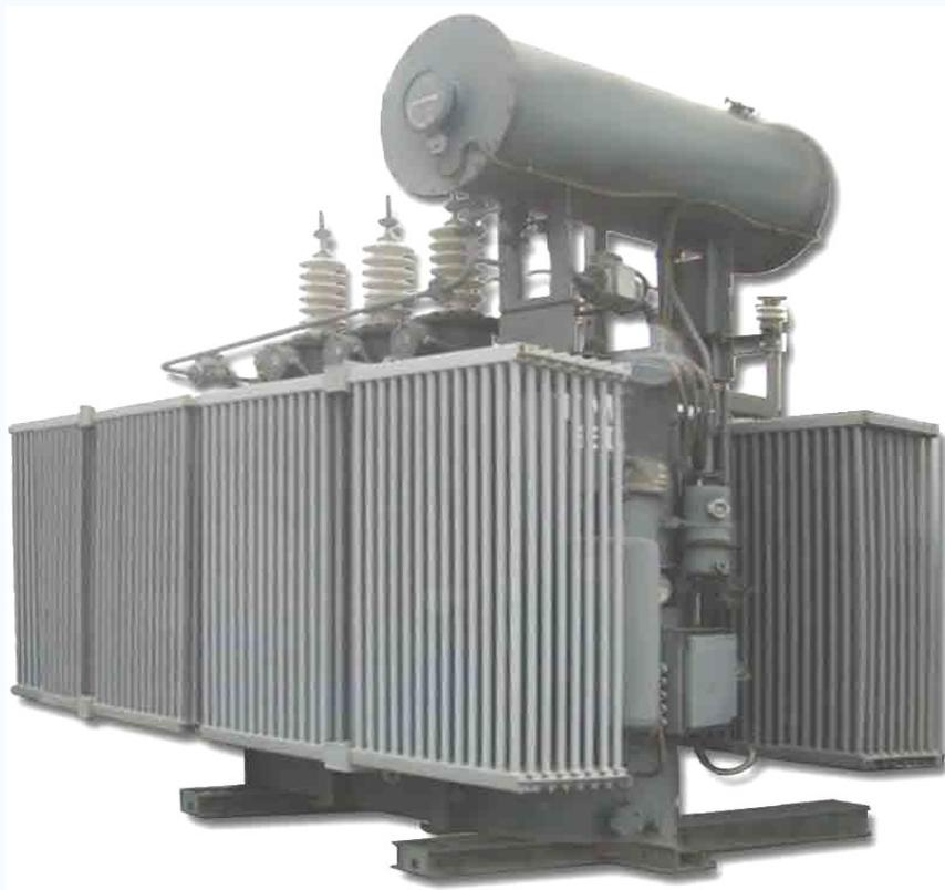
Трансформаторы трехфазные, двухобмоточные, масляные, с естественной циркуляцией масла и принудительной циркуляцией воздуха, с переключением ответвлений без возбуждения (ПБВ), с диапазоном регулирования  $\pm 2 \times 2,5\%$ , предназначены для преобразования напряжения в сетях 35 кВ.
