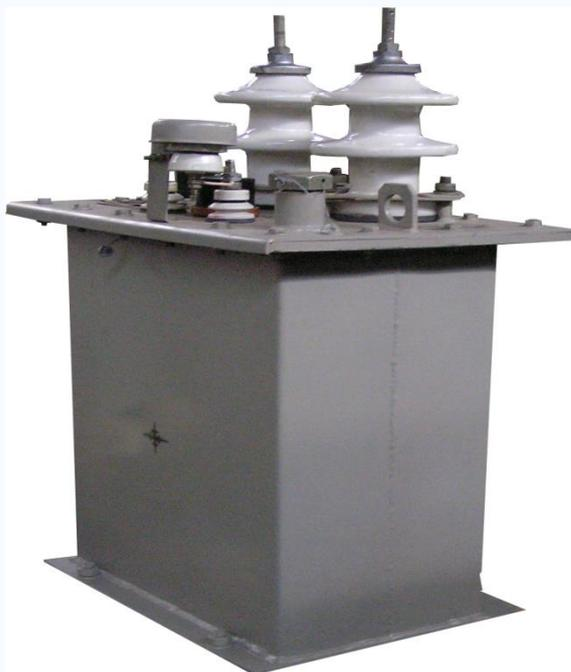
Трансформаторы однофазные масляные класса напряжения 10кВ с регулированием ПБВ, климатического исполнения У1, со схемой и группой соединения обмоток 1/1-0. Предназначен для питания устройств катодной защиты, а также могут быть использованы для питания других однофазных потребителей.
