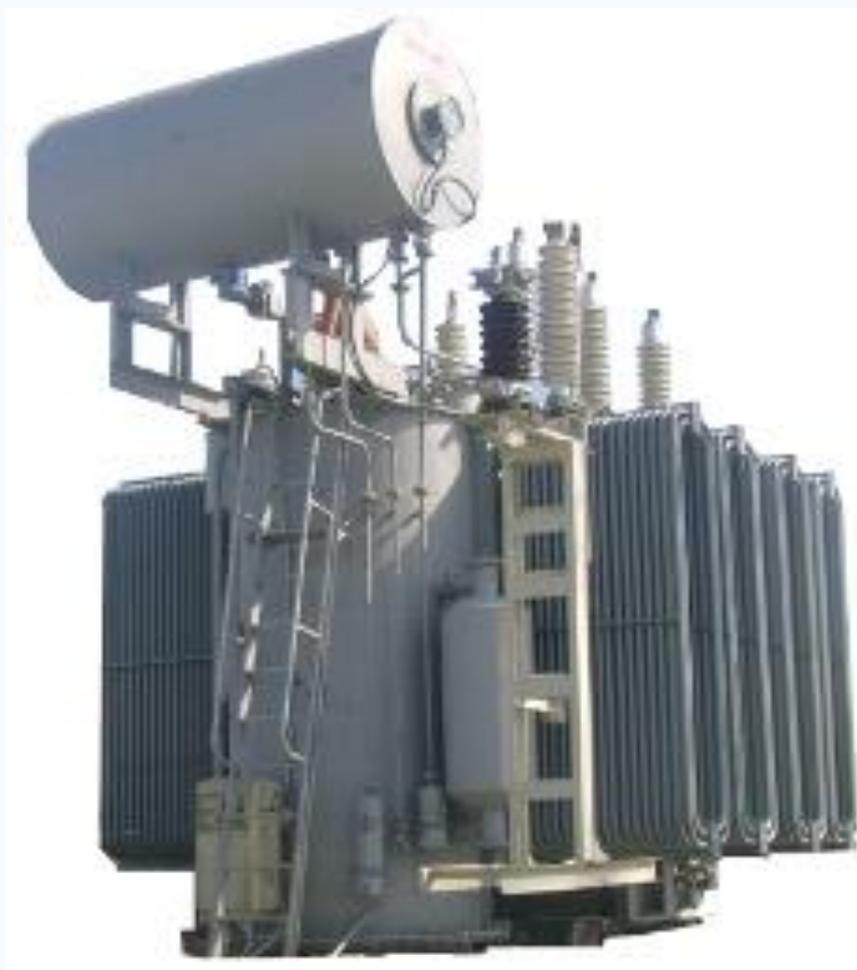
Трансформаторы ТМ, ТД трехфазные, двухобмоточные, с естественной циркуляцией воздуха и масла, с переключением ответвлений без возбуждения (ПБВ), с диапазоном регулирования  $\pm 2 \times 2,5\%$ , предназначены для преобразования и поддержания заданного уровня напряжения в распределительных сетях в районах, отдаленных от промышленных зон, и для работы в электрических сетях общего назначения.
