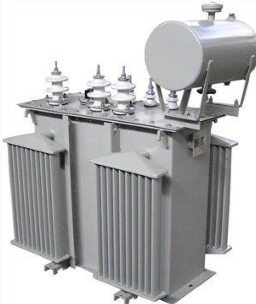
Трансформаторы типа ТМ-25÷630/6(10) У1 силовые, трехфазные, двухобмоточные, с естественным масляным охлаждением, с переключением ответвлений без возбуждения (ПБВ). Изготавливаются для районов с умеренным (У) и тропическим (Т) климатом с перепадом температур минус 45°С плюс 40°С для климатического исполнения У и минус 10°С плюс 55°С для климатического исполнения Т.
