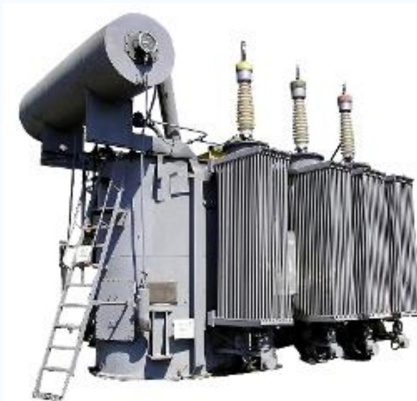
Трансформаторы трехфазные, двухобмоточные, с естественной циркуляцией масла и принудительным обдувом воздуха, с регулированием напряжения под нагрузкой (РПН), предназначены для преобразования и поддержания заданного уровня напряжения в распределительных сетях в районах, отдаленных от промышленных зон, и для работы в электрических сетях общего назначения.
