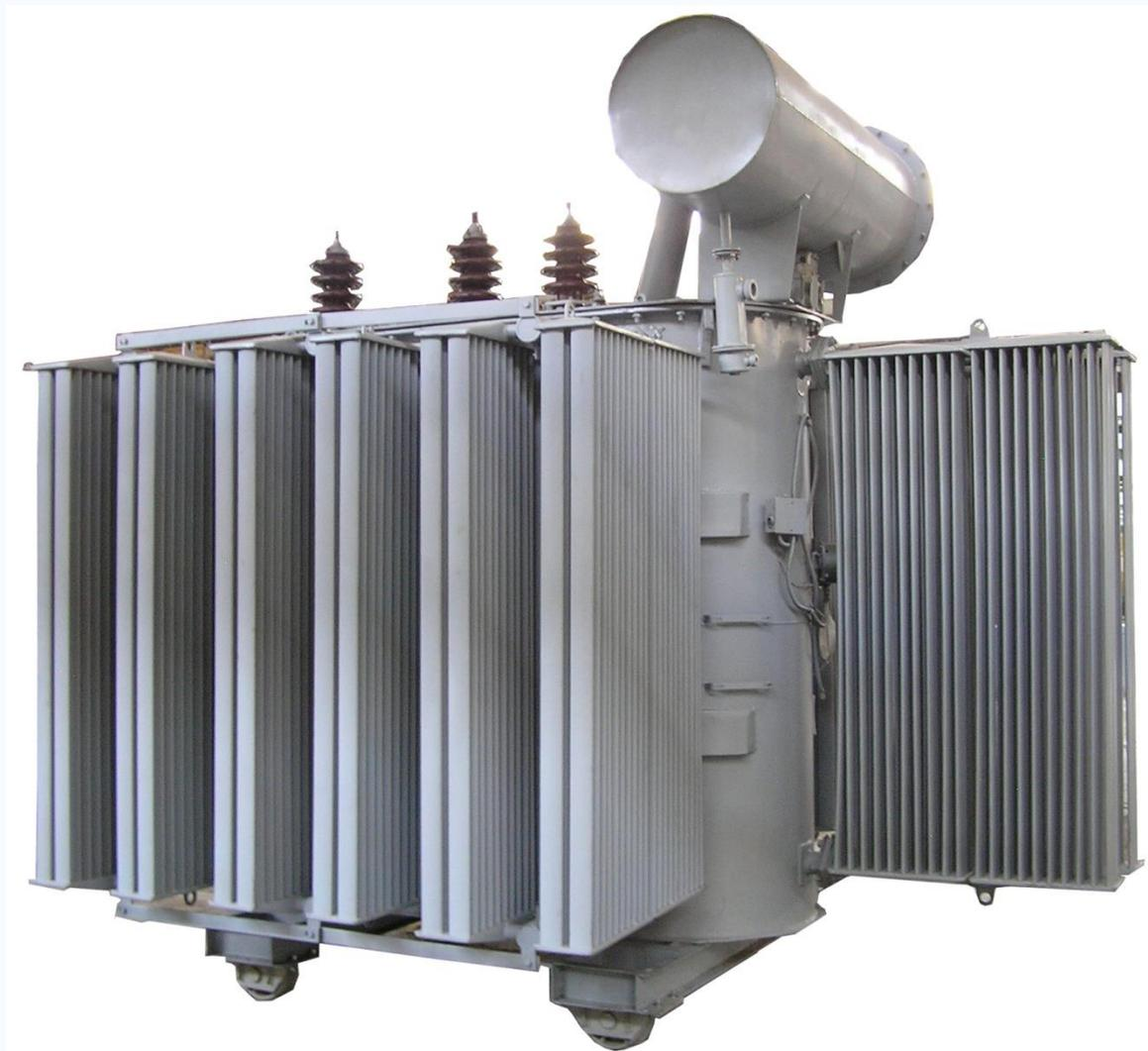
Трансформаторы ТМ трехфазные, двухобмоточные, масляные, с естественным масляным охлаждением, с переключением ответвлений без возбуждения (ПБВ), с диапазоном регулирования  $\pm 2 \times 2,5\%$ , предназначены для преобразования напряжения в сетях 35 кВ.
