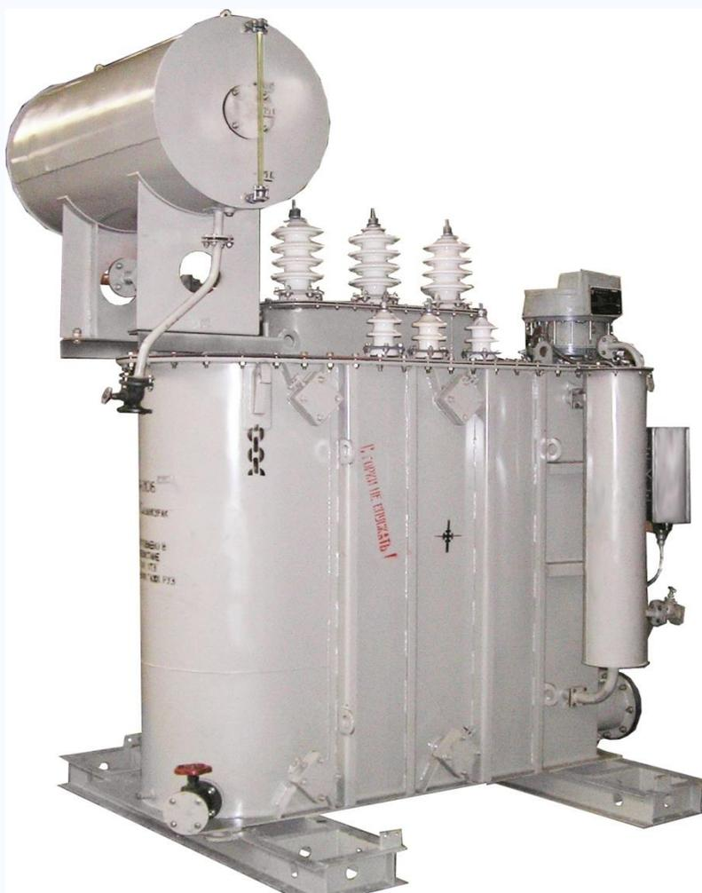
Трансформаторы ТМН и ТМНП трехфазные двухобмоточные, масляные с естественным масляным охлаждением, с регулированием напряжения под нагрузкой (РПН), с диапазоном регулирования  $\pm 4 \times 2,5\%$  предназначены для преобразования напряжения в сетях 35 кВ.
