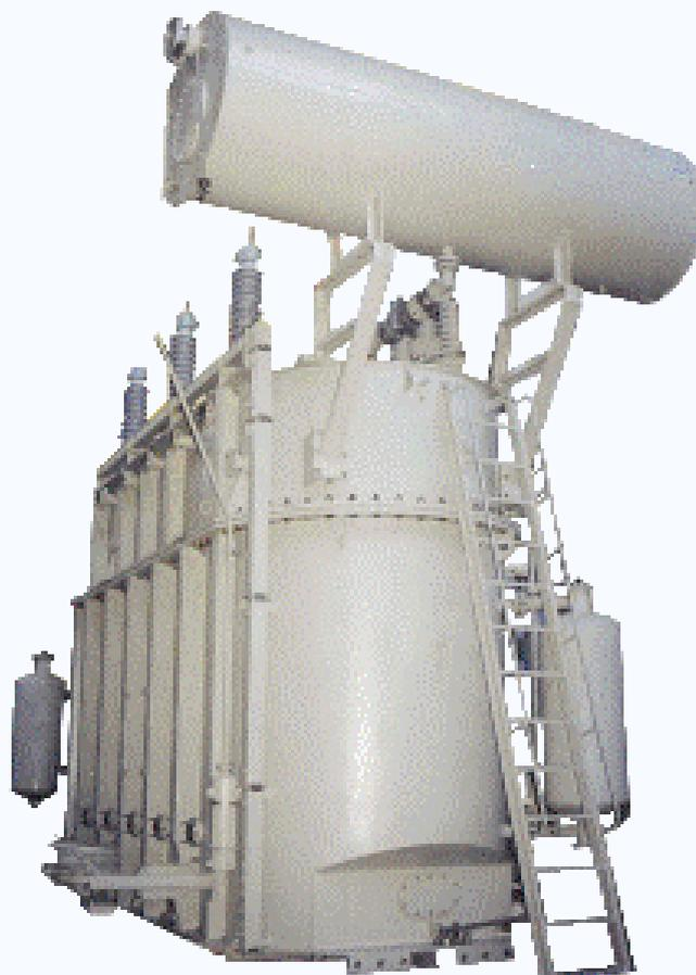
Трансформатор ТДТНЖ силовой, трехфазный, трехобмоточный, колокольного типа, с естественной циркуляцией масла и принудительной циркуляцией воздуха, с регулированием напряжения под нагрузкой (РПН), с диапазоном регулирования  $\pm 9 \times 1,78\%$  со стороны ВН.
