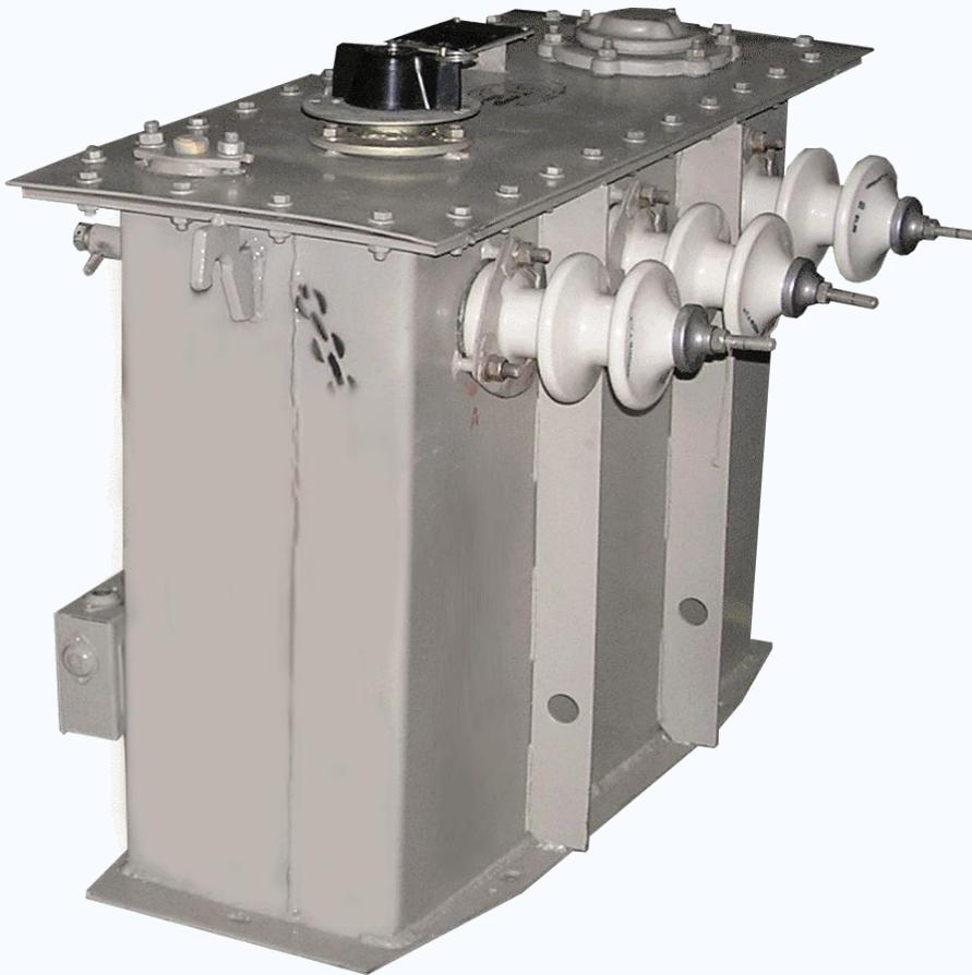
Трансформаторы типа ТМЗ-25÷2500/6(10) У1,3 и ТМЗ-25÷2000/6(10) Т1,3 силовые, трехфазные, двухобмоточные, герметичные, с естественным масляным охлаждением, с переключением ответвлений без возбуждения (ПБВ). Изготавливаются для районов с умеренным (У) и тропическим (Т) климатом с температурой окружающего воздуха от минус 45°С, плюс 40°С для климатического исполнения У и минус 10°С до плюс 55°С для климатического исполнения Т. Обмотки изготавливаются в алюминиевом и медном варианте.
